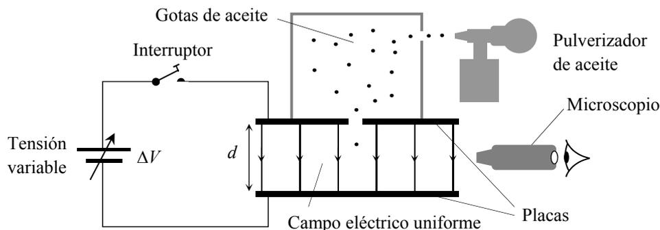
En una de las variantes del experimento de Millikan, se mide en primer lugar la velocidad límite de caída,  $v_0$ , en ausencia de campo eléctrico. A continuación se conecta el campo y, observando por el microscopio, se ajusta  $\Delta V$  hasta conseguir que la gota permanezca en equilibrio, sin subir ni bajar. Llamaremos  $\Delta V_0$  al valor de la diferencia de potencial entre las placas que consigue este equilibrio.
