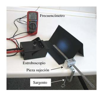
Para una serie de longitudes L de la regla, se ajusta la frecuencia F del estroboscopio hasta conseguir que la regla vibrante se vea aparentemente quieta, y esta frecuencia de iluminación se mide con un frecuencímetro. En la siguiente tabla se presentan los resultados obtenidos, suponiendo f = F:
